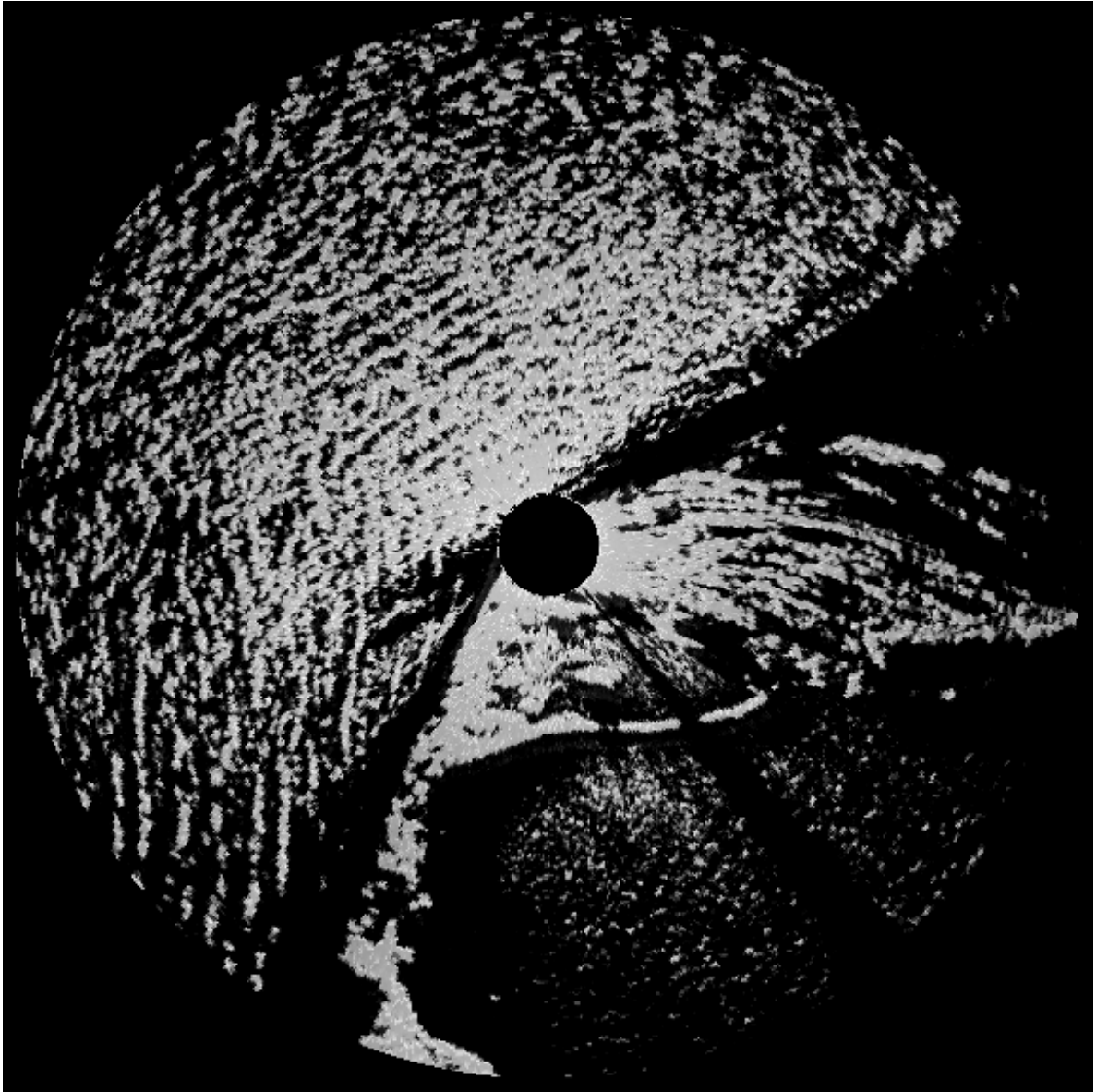
Abb. 2.3: Mit WaMoS II ® erzeugtes und gespeichertes Radarbild von ca. 2x2-km-Fläche, Messgebiet List-West auf Sylt. Schwarzer Kreis in der Bildmitte stellt den Totbereich des Radars (GKSS/KOR 2001).
